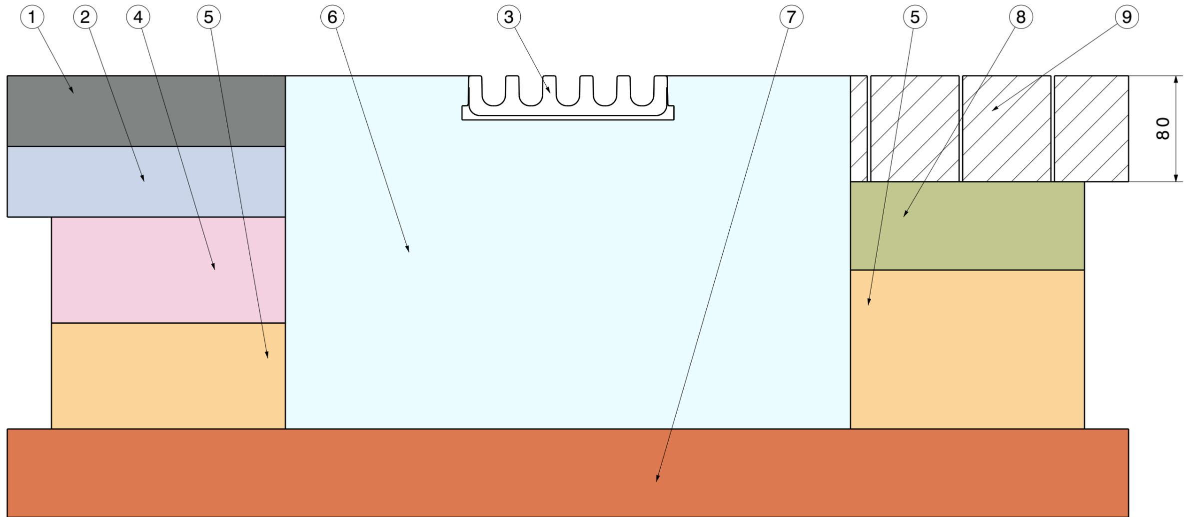
1. Bituminöse Deckschicht ca 4 cm stark
