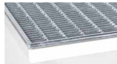
Pressgitter-Kantenschutzrost Maschenweite 30/10* für Belastungen bis 7,2 kN
