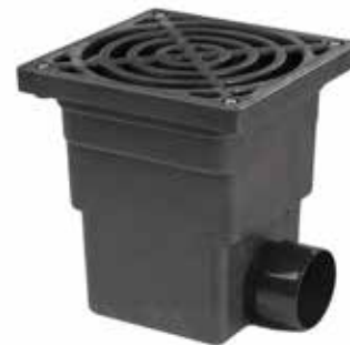
Hofeinlaufkasten mit Gusseisenrost Klasse B 125 und Geruchsverschluss
